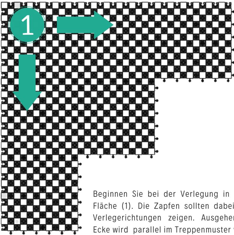
Beginnen Sie bei der Verlegung in einer Ecke der Fläche (1). Die Zapfen sollten dabei in die beiden Verlegerichtungen zeigen. Ausgehend von dieser Ecke wird parallel im Treppenumuster verlegt.
