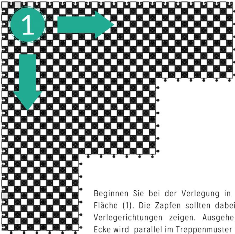
Beginnen Sie bei der Verlegung in einer Ecke der Fläche (1). Die Zapfen sollten dabei in die beiden Verlegerichtungen zeigen. Ausgehend von dieser Ecke wird parallel im Treppemuster verlegt.
